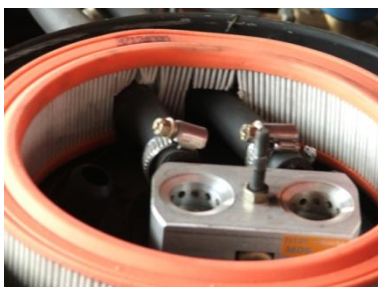
Slika 4: Cevi niskog pritiska provedene do mešača sečenjem filtera za vazduh.
