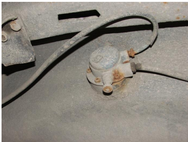
Slika 8: Multiventil torusne boce montiran na spoljašnjem obodu rezervoara sa spoljne strane kućišta rezervnog točka – ispod patosa vozila. Nema zaštite armature (silikonsko kućište protiv kamenja i dejstva rđe).
