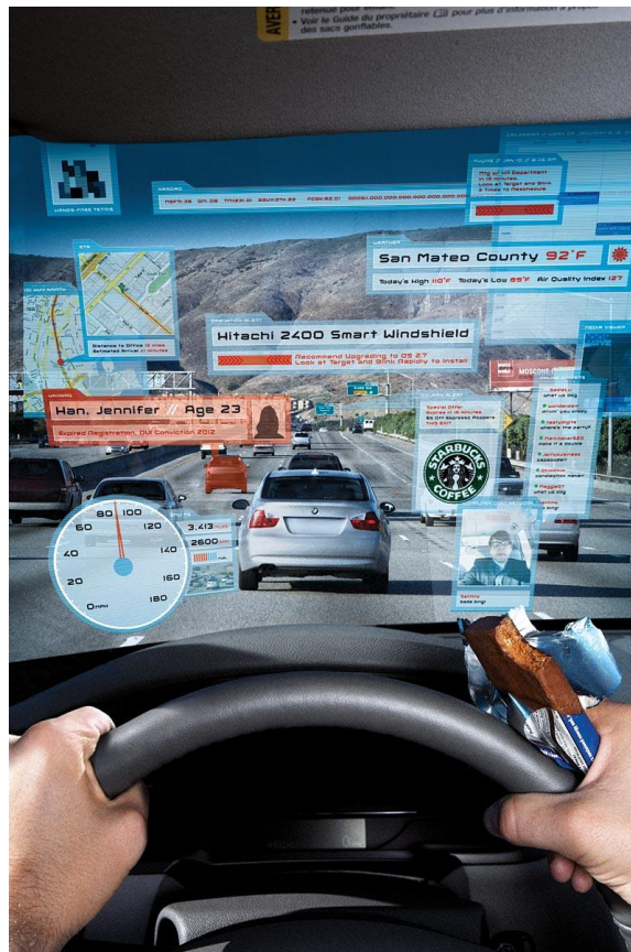
Slika 4. Prikaz unapređenog Head-up Display kod putničkog vozila gledano iz perspektive vozača
