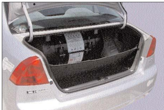
Slika 3. Rezervoar sa CNG
