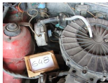
Slika 5: Cev niskog pritiska uvedena u kućište filtera sa metalnom cevi bez mešača. Cevi visokog pritiska nisu zaštićene plastičnim bužirrom.
