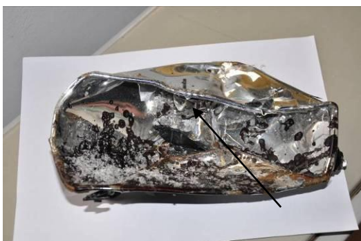
Sl.22 Kućište fara sa razbijenom sijalicom
