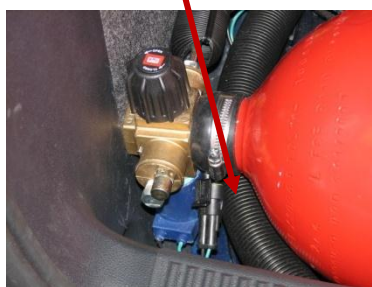
Slika 11. Primer čvrste ugradnje – nepravilno je što ne postoji hermetičko kućište pribora rezervoara.
