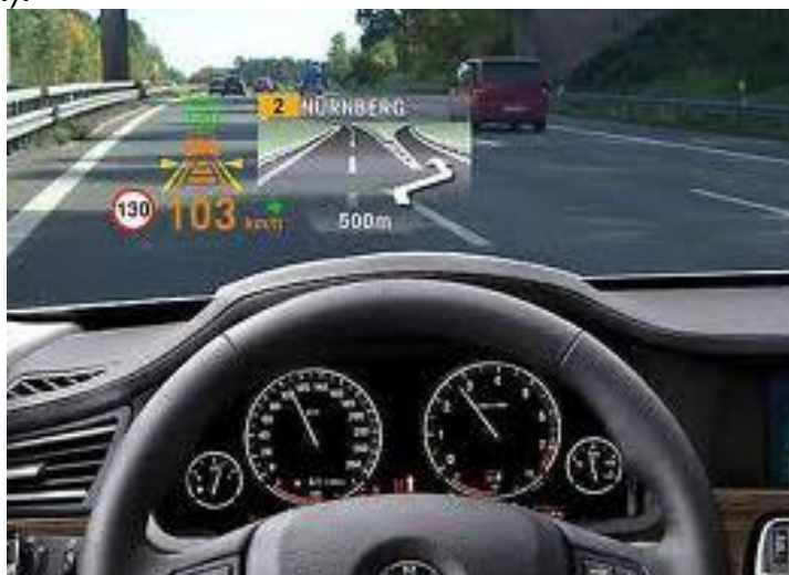
Slika 3. Prikaz Head-up Display kod putničkog vozila gledano iz perspektive vozača
