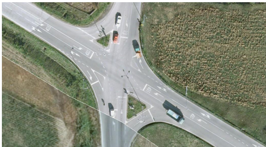
Slika 9. Geometrija raskrsnice sa horizontalnom signalizacijom u NIGP
