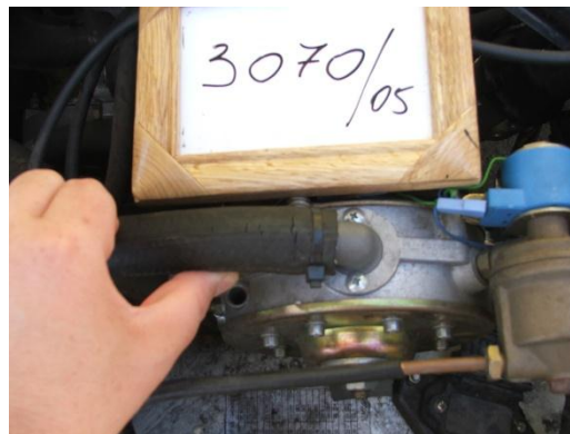
Slika 9: Nekvalitetne i neodgovarajuće cevi na vodovima za vodu i gas niskog pritiska. Nakon godinu dana od montaže opasno su ispucala.
