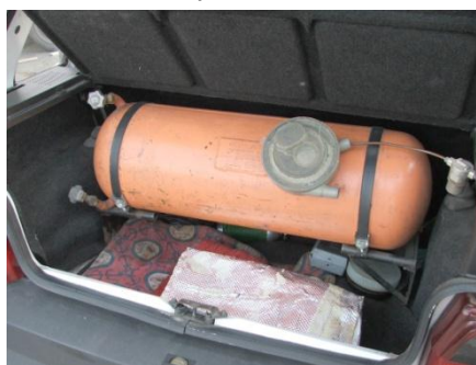
Slika 7: Na rezervoaru su dovarena dva priključka sa slavinama.
